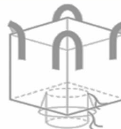
Modelo C3 Big Bag com abertura total e válvula inferior de descarga.
